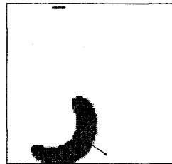
図 37: banana-like スポットのスナップショット。スポットとして耐え切れず、進行方向と垂直にバナナ状に延びる。壊れず直進し続ける。 i_u = 1.2, D = 0.03
