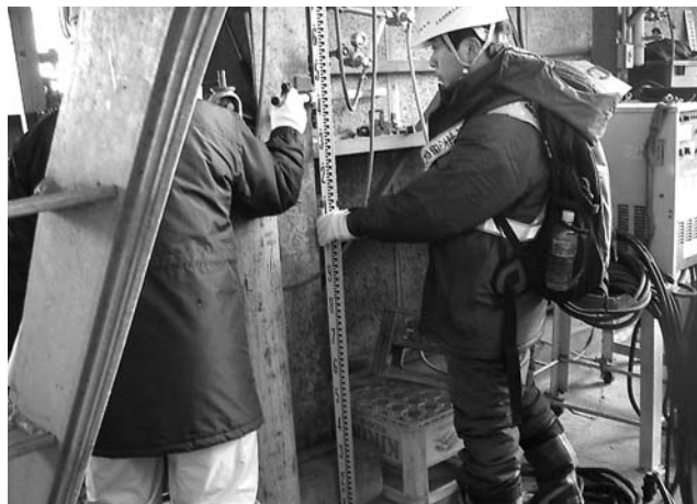
写真2 浸水高の測量 (痕跡位置を左側調査員が示す)
