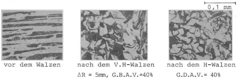
Bild 8-9 Mikrostruktur der Probe vor dem Walzen und des Walzgutes nach dem V.H- und H-Walzen
