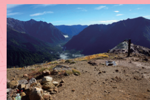
焼岳山頂での地震・電磁気観測の例。中央右のビットに地震計、右後方のピラーに磁力計が収容されています。後方は上高地。
