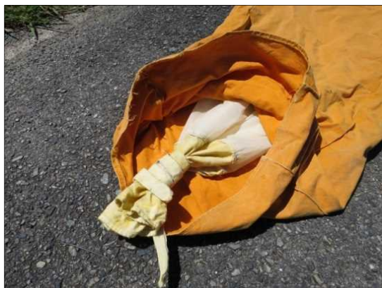
図 5. メイオベントス用ドレヅの袋部。外袋（キャンバス生地）と内袋（目合い 0.2 mm のプランクトンネット生地）の二重構造。
