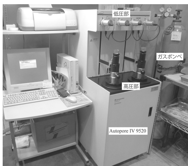
図-2 本研究で使用した水銀圧入式ポロシメータAutopore IV 9520の写真
