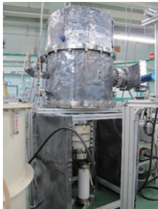
図1 D-D中性子発生装置
