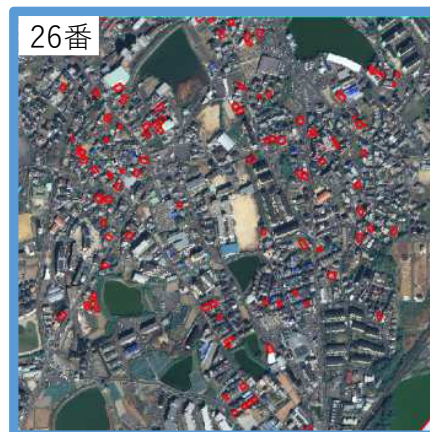
(a) 風速が高い（約 27m/s）グリッドの屋根被害住宅の分布（赤く囲まれている建物が屋根被害を受けた住宅、(b)も同じ）
