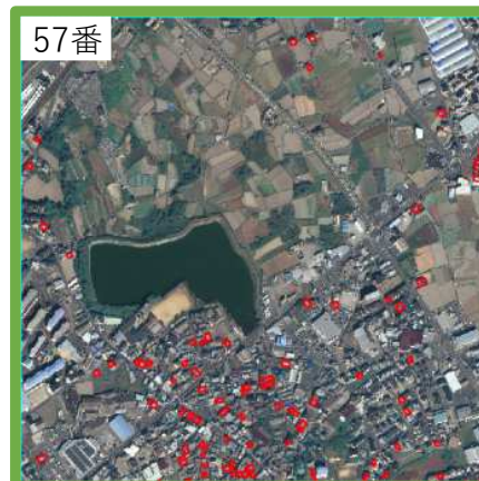
(b) 風速が低い（約 22～23m/s）グリッドの屋根被害住宅の分布
