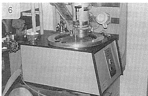
1—6：スライドガラスに接着し約1 mm までに切断された土壌サンプルを、岩石研磨機を用いて0.1 mm 程度まで研磨を行う。
