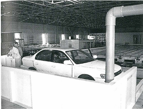
写真 5-1 実物大の車模型と水槽
