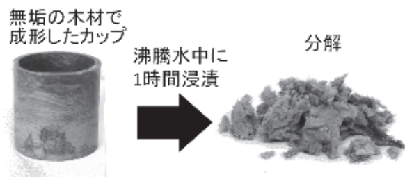
図3：無垢の木材の流動成形体の煮沸処理による分解
