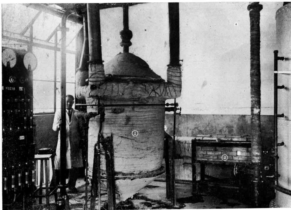
第一圖 試験装置の一部 ① 有機硫黄除去装置 ② 加熱用燃焼ガス装置
