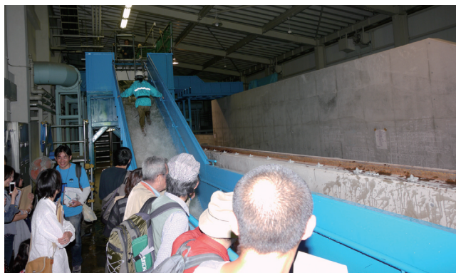
写真 2 階段流水実験
