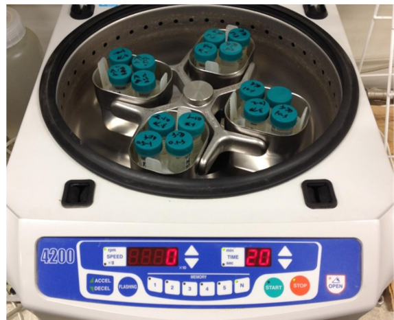
(d) Centrifugation under 3,000 rpm
