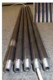
写真-2 有孔管 φ19mm（内径 7mm）
