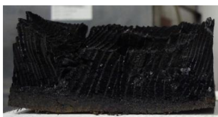
図 8.2-2 加熱強度 50\text{kW/m}^2 の実験の終了後断面写真
