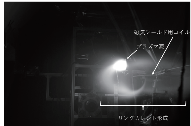
図1：リングカレント形成時の撮像写真
