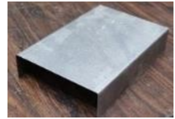
図5 仕切りの鋼板
