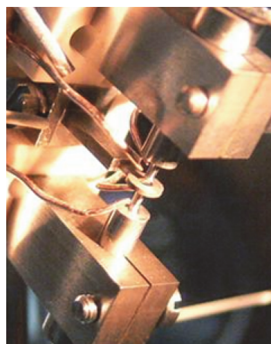
図 6 イオントラップ。中央のリング状の空間、直径 800\ \mu\text{m} の中央にイオンはトラップされる。
