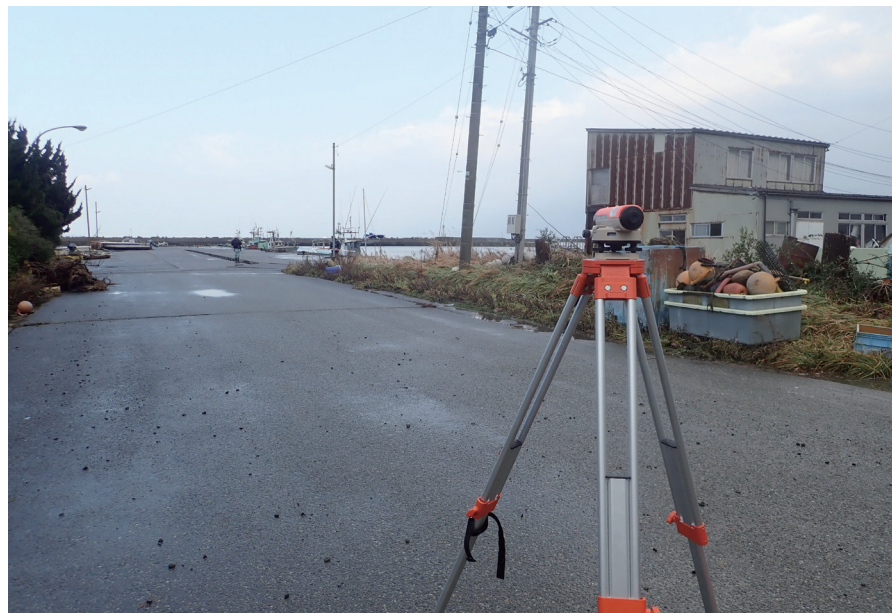
図1 津波痕跡高の測量の一例。海面から痕跡までの高さを水準測量によって測り、その時の天文潮位をもとに高さの補正を行います。
