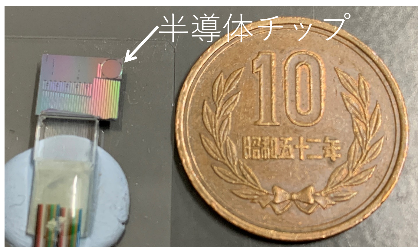
図2 集積化が可能な半導体量子もつれ光子源
