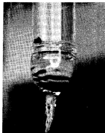
写真2：ガラス管下端にぶら下がる気泡 表面に生じた周期的な縞模様
