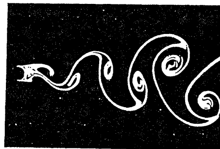
図4 円柱後方のカルマン渦列。 R = 140
