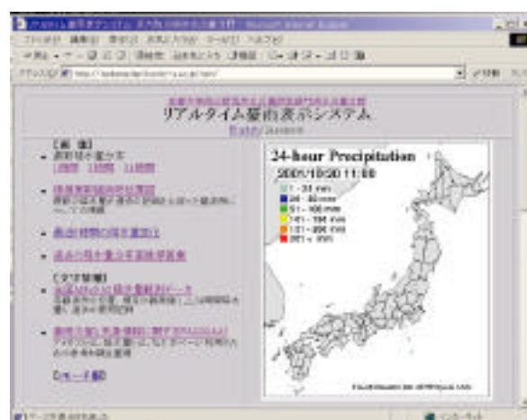
図10 筆者らが整備しているリアルタイム豪雨表示システム ( http://www.disaster-i.net/rain/ iモードからは http://www.disaster-i.net/imode/ )
