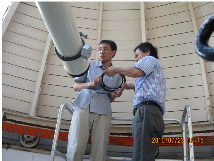
図2 ザートリウス 18cm 屈折鏡にプリズムを装着する富田良雄、前原両氏（筆者撮影）
