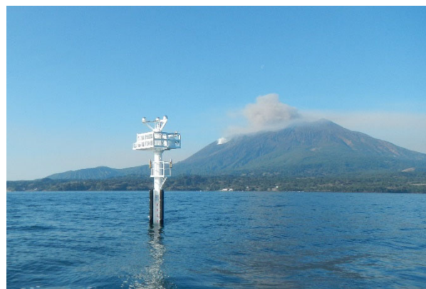
海底地盤変動観測装置
