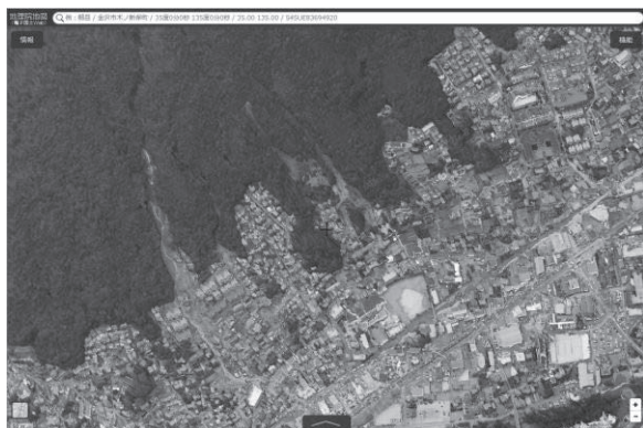
写真4 斜め写真から作成された正射画像。
