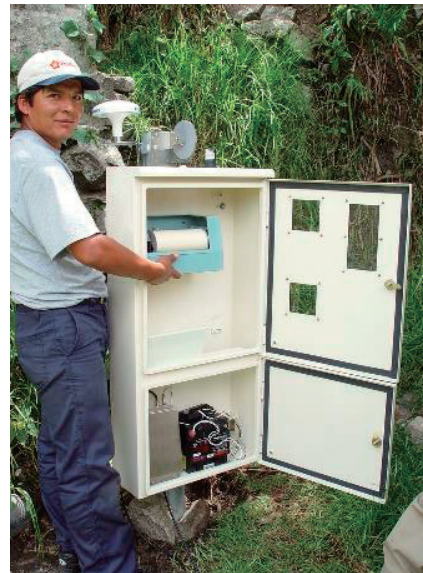
世界遺産マチュピチュの斜面に設置した斜面変動観測システム
