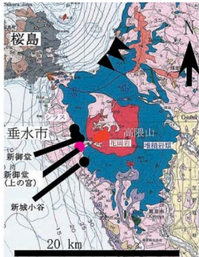
図2 垂水市周辺の地質図（地質調査所の20万分の1地質図より）。●は崩壊と土石流、●はシラスの崩壊、▼は土石流の流出箇所を示す。
