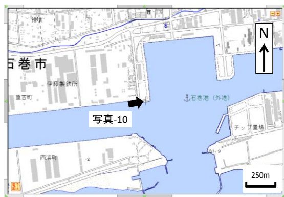
図 10 石巻港中島埠頭岸壁南端部の陥没(写真 10)の位置図(国土電子ポータルに加筆)
