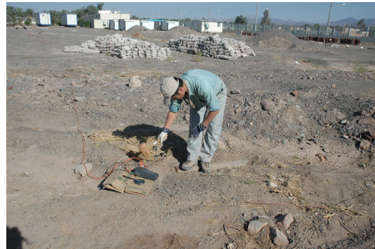
写真 1 弾性波探査実施状況
