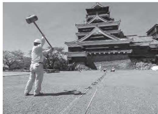
写真-3 表面波探査の実施状況（本丸，測線7）
