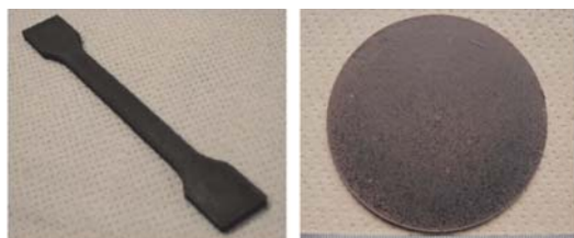
図 4-35：クエン酸接着木質成形体
