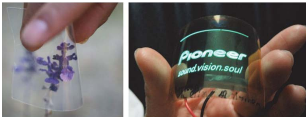
図 4-24：セルロースナノファイバー補強透明材料（左）とそれを基板に用いた有機 EL 発光素子（右）
