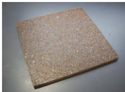
図 4-36：クエン酸とスクロースによって接着したパーティクルボード
