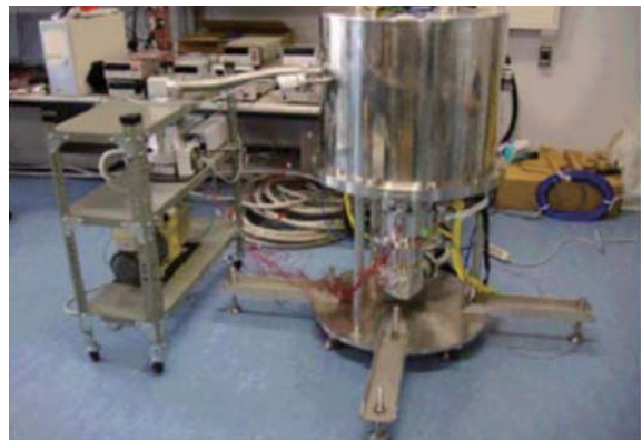
図 5-19：磁気セイル超伝導コイル実験用チャンバ
