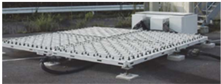
図 2-8：下部対流圏レーダーのアンテナ
