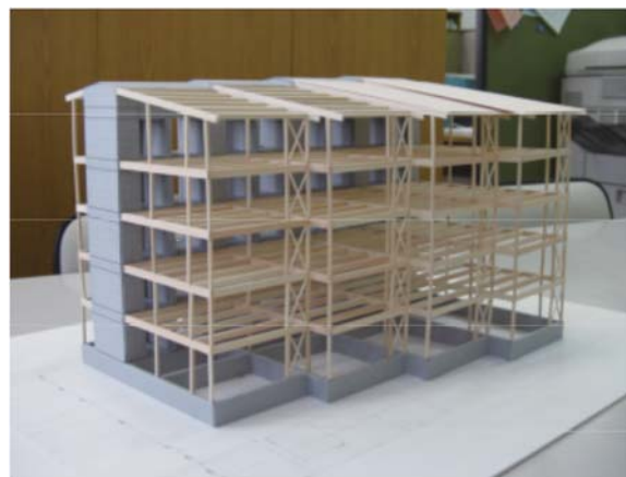
図 6-12：RC造と木造を組み合わせた構造
