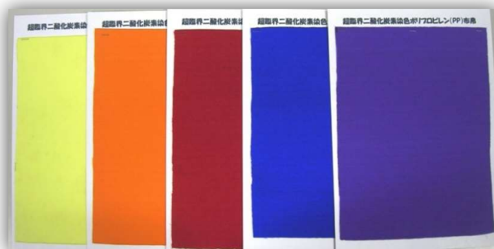
図 4：超臨界二酸化炭素で染色された PP 布帛 18)
