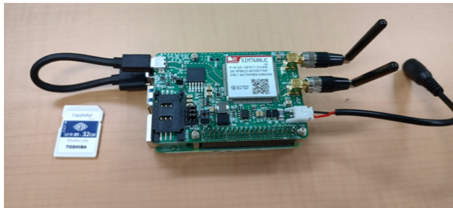
写真 1. FlashAir と 4GPi を搭載した Raspberry Pi
