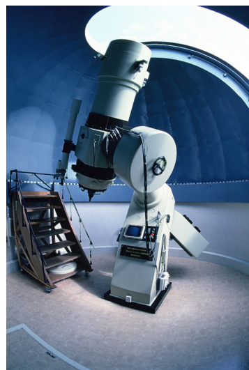
神和光機50cm反射望遠鏡 鏡面研磨：池谷薫氏
