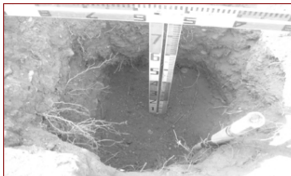
写真-1 植物園の土で埋めた穴に侵入してきた根の様子
