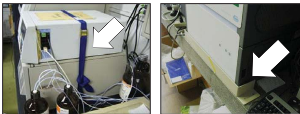
図 2. 重ねた機器の連結（左）と返しの設置（右）
