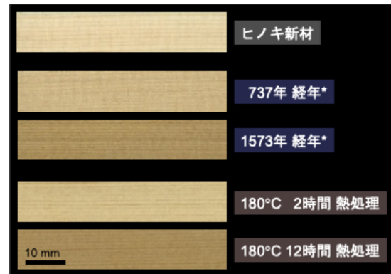
図2：ヒノキ新材，古材，熱処理材の比較 （*経年時間は、年輪年代法により求められた試料最外年輪の生育年代から算出 20) ）
