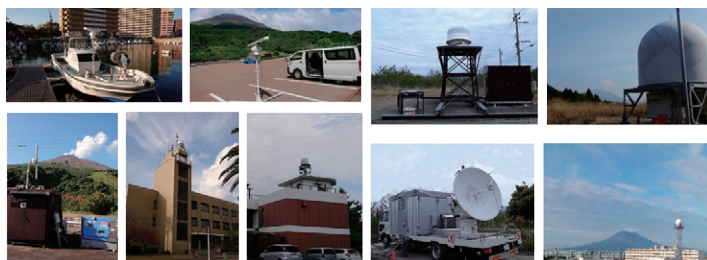
図1 桜島の噴煙観測に用いられたさまざまなタイプの気象レーダ
