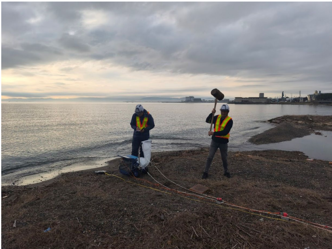
図-7 陸上表面波探査の状況
