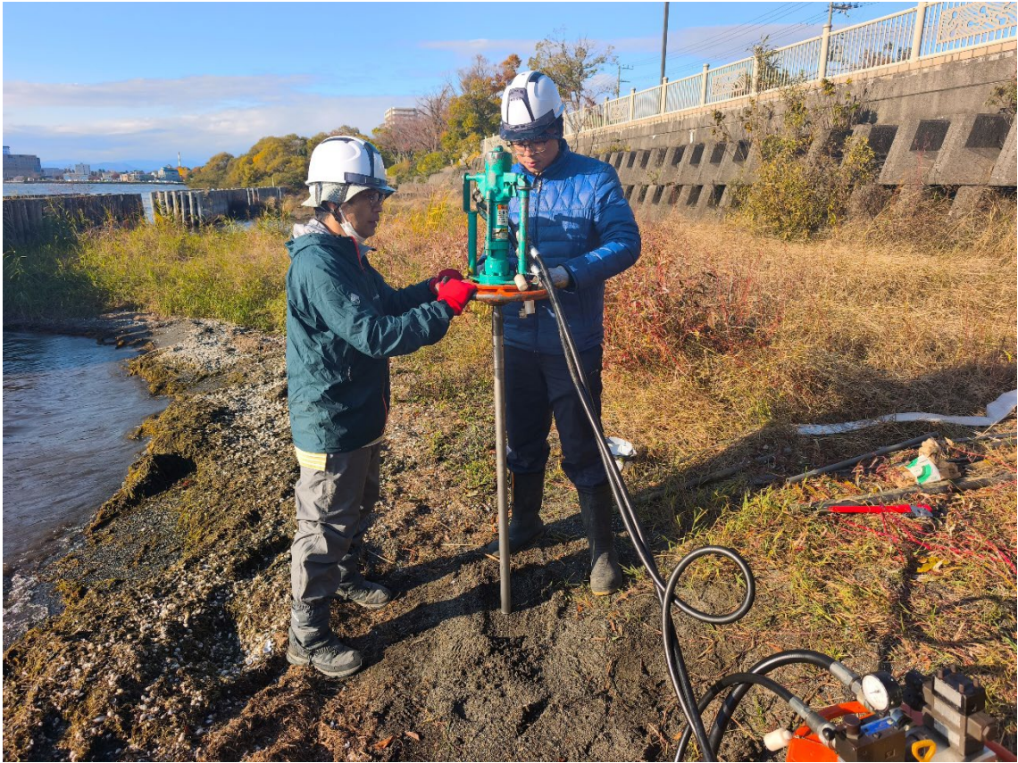
図-10 バイブロハンマーサンプラーの作業状況
