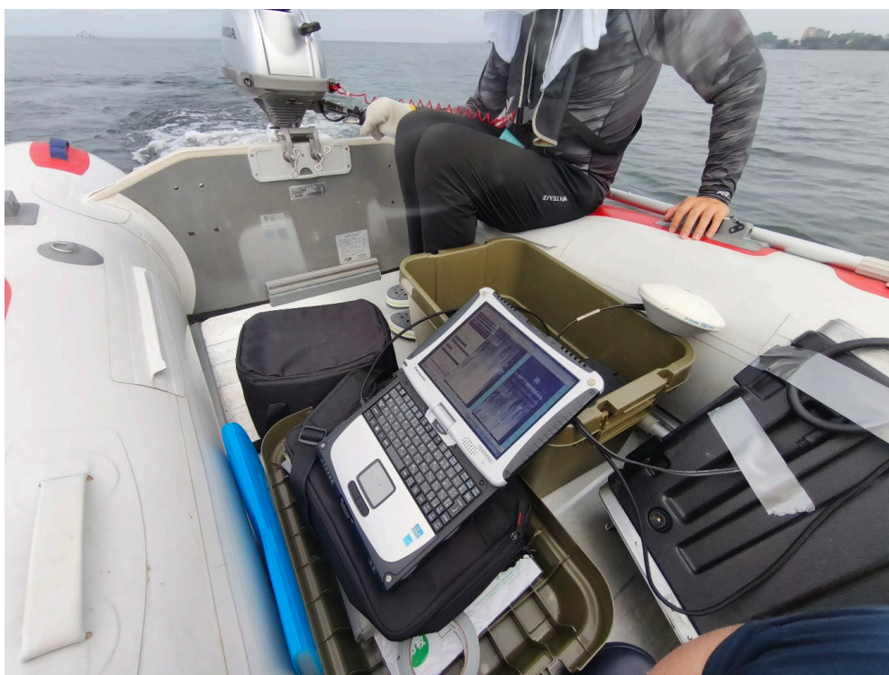
図-6 CHIRP サブボトムプロファイラ Bathy-2010PC による調査状況
