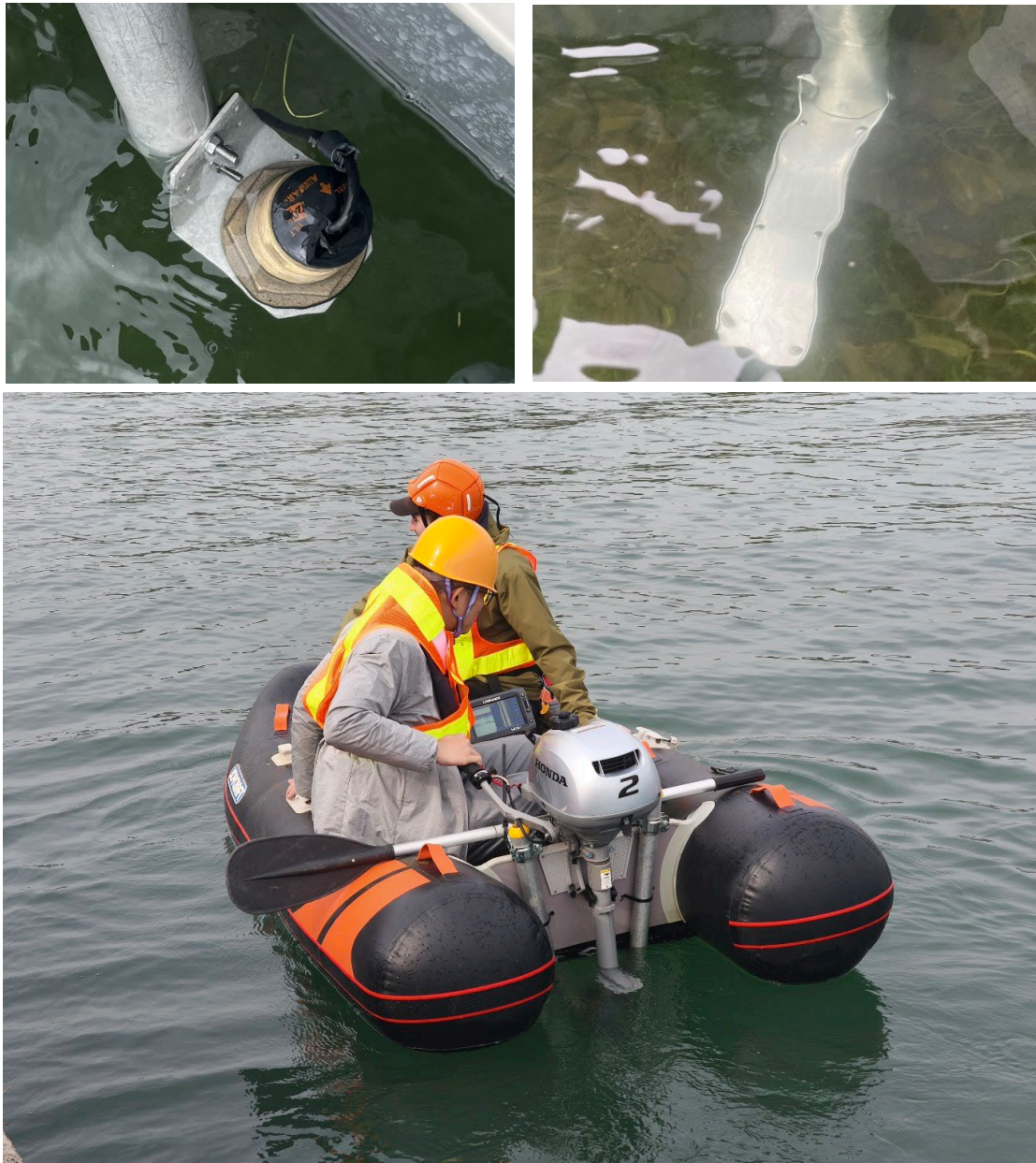
図-5 GNSS 魚群探知機による調査の状況と使用した振動子（上）
