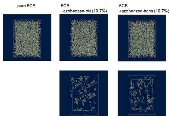
図 1 液晶秩序度に対する不純物の効果に関する分子動力学シミュレーションのスナップショット。左：液晶分子 (5CB) のみ、中央： cis 体の azobenzene 添加。右： trans 体の azobenzene を添加。下段は不純物の分布のみを取り出したもの。
