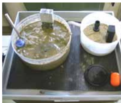
写真 15. 模型実験 液状化
