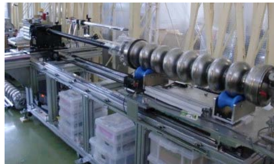
図3：内面検査カメラ（京都カメラ）
