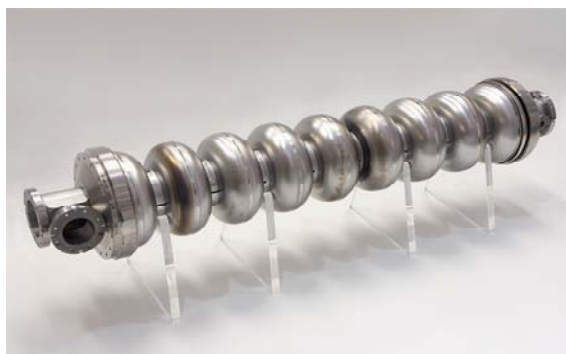
図 2：ニオブ製 9 セル超伝導加速空洞 （長さ約 1.2m）
