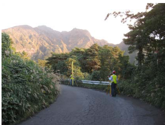
図 1. 桜島での水準測量
