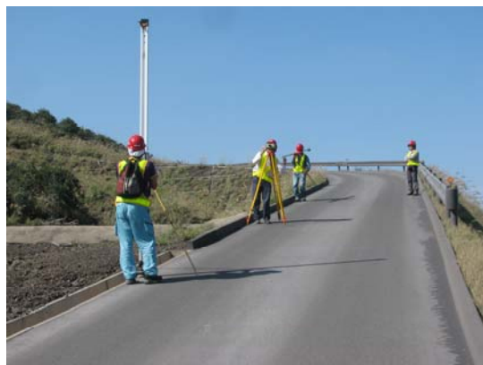
図 2. 水準測量時の標準的な班構成
