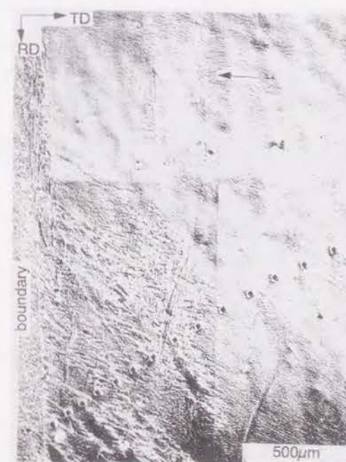
Figure 5.8 70%圧延後のFe-19%Cr単結晶II ((001)[110]方位、拡散接合材)のND面上の光学顕微鏡組織と、各点のビッカース硬度。Load=0.98N
