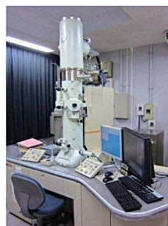
無機用電界放出形 電子顕微鏡
