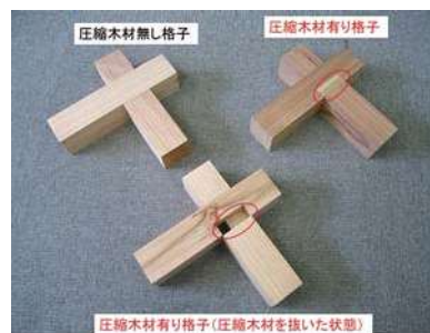
図1 圧縮木材を用いた面格子耐力壁のイメージおよび接合模型
