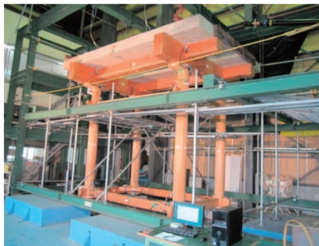
図2 伝統木造工法の模型試験体(立命館大学)
