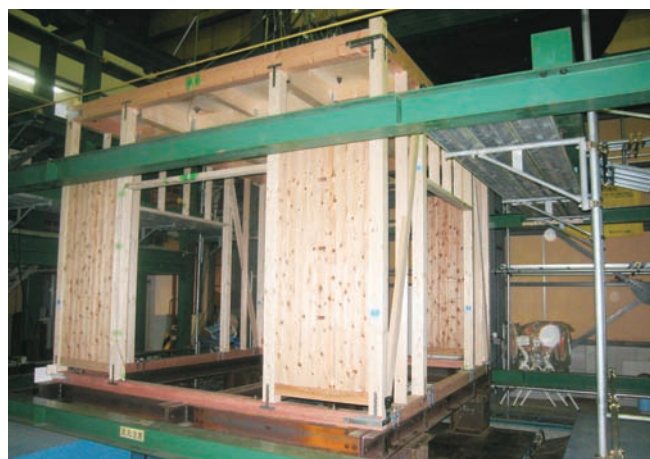
図1 壁柱工法の実大試験体(大阪府木材連合会)
