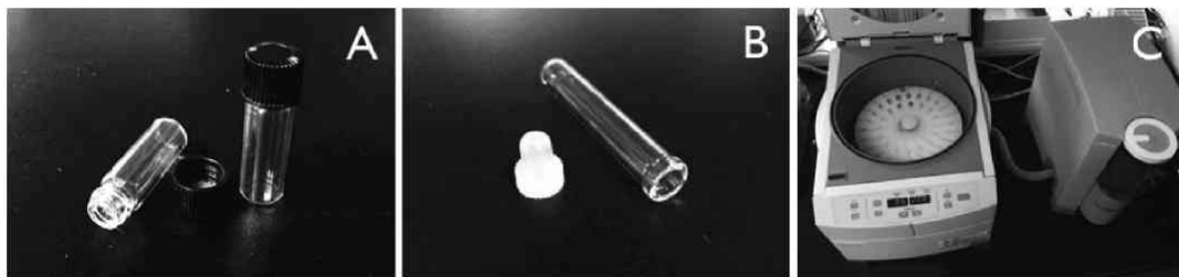
図1:ミクロスケールプロトコールに用いる器具及び装置 (A)1ml ガラスバイアル, (B)1ml ガラスマイクロチューブ, (C)遠心濃縮機
