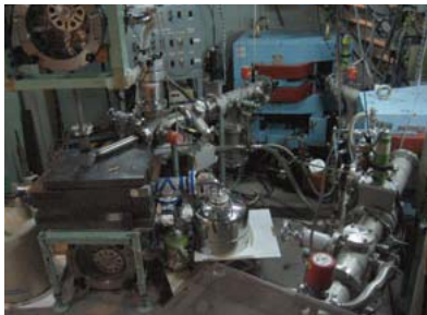
オンライン同位体分離装置の写真。 原子炉の中性子を利用して生成された不安定原子核が、電磁石(青色)により同位体毎に分離されて、末端の測定ポートへ運ばれ、各種検出器を用いて、放射線が測定されます。(ダクト中を不安定核のビームが通ります。)
